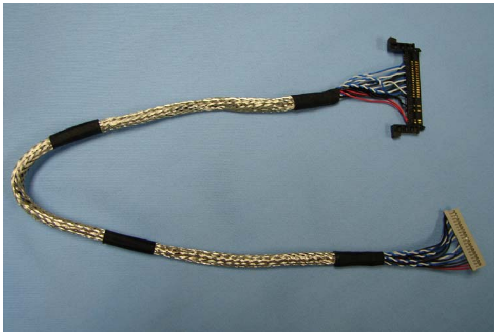
Foto 5. 1. Cable Conexión TFT
