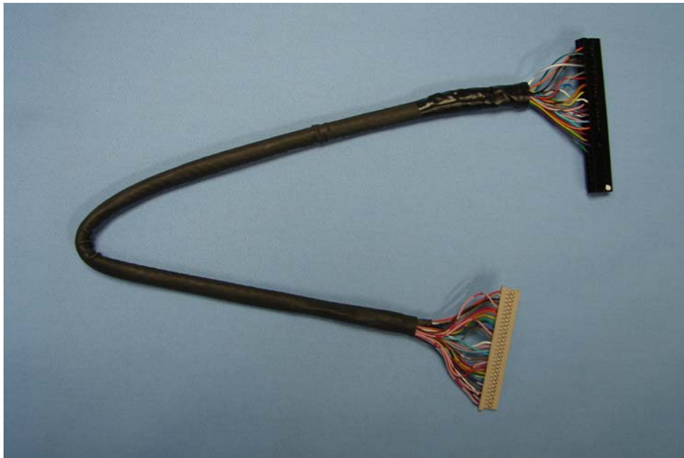
Foto 4.1. Cable Conexión TFT
