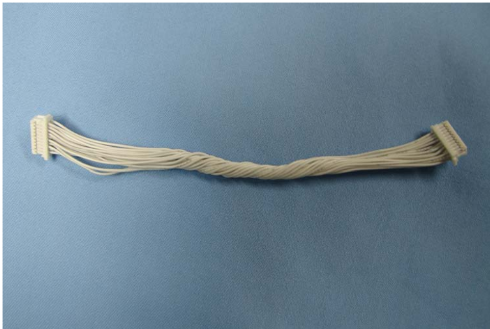
Foto 2. 1. Cable conexión placa TFT
