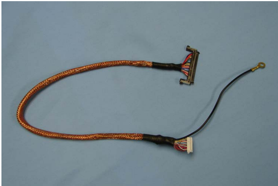
Foto 3. 1. Cable Conexión TFT
